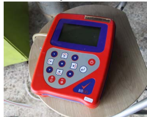
รูปที่ 1 เครื่องวิเคราะห์องค์ประกอบก๊าซชีวภาพ
